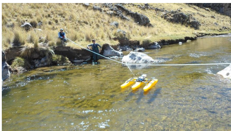
Aforo en el río Hornillos, aguas arriba de la confluencia con el río Apurimac, 24 de abril, 2013.
