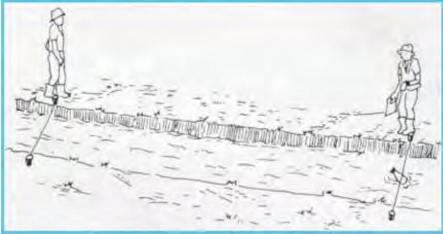
Figura 7. Cuando el flotador pasa por la segunda medida, se termina de tomar el tiempo. Se recupera el flotador. Con el tiempo determinado se apunta en el cuaderno, esta acción se realiza mínimo 5 veces
