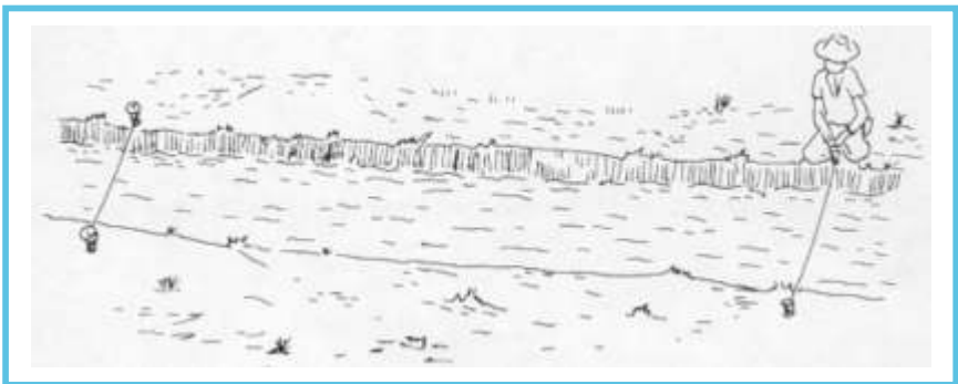
Figura 2. Marcar con alambre o cordel sobre el canal el inicio y el término del sector a medir.
