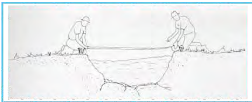
Figura 3. Medir el ancho del canal
