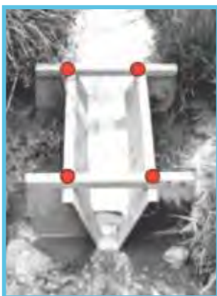
Figura 9. Golpear despacio en los puntos para que quede nivelado el aforador RBC
