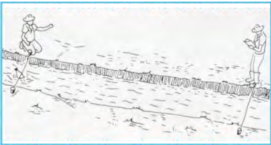
Figura 6. Cuando el flotador pasa por la línea del punto inicial A avisara con un grito al personal que se ubica en el Punto de la Línea B para que inicie el conteo a través de un cronometro de tiempo.
