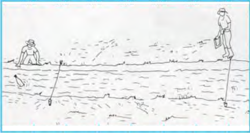
Figura 5. Lanzar el flotador al canal 3 metros antes del punto A
