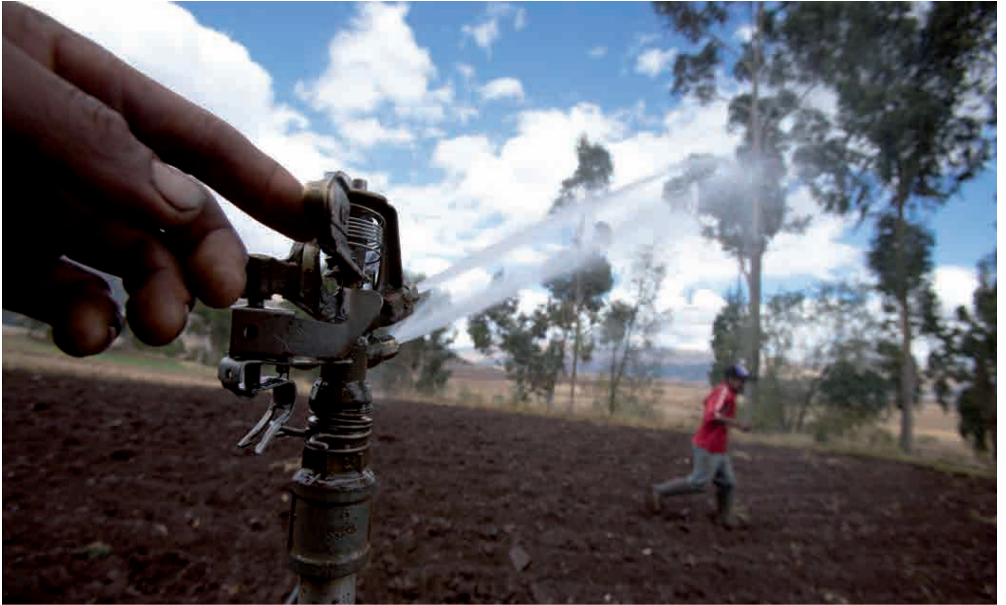
RIEGO POR ASPERSIÓN. Este sistema es combinado con el de riego por gravedad en muchas chacras de maíz de Mosoqllacta.
