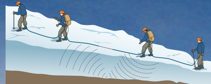
Medición de espesor de hielo con Radar de Penetración Terrestre - GPR
