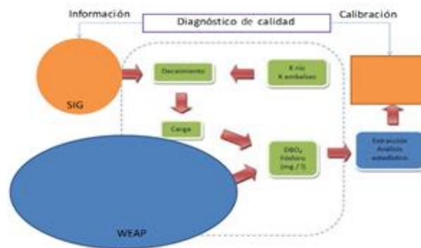
Ilustración IV: Proceso de modelación de la calidad de aguas.
