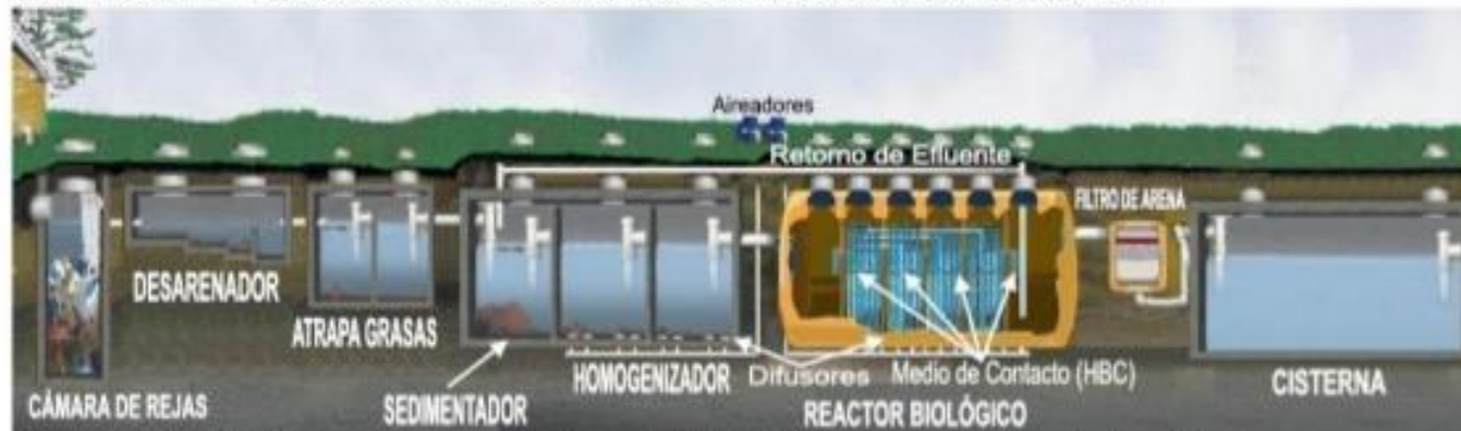
Figura 1: Sistema de Tratamiento integral 100% biológico con medio de contacto y filtro de arena.
