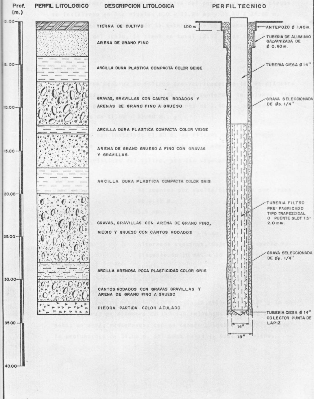
En efecto se instalaron módulos de tubería de fierro de 14" x 1/4" para conformar la columna definitiva del pozo. Los tramos ciegos se instalaron en los niveles 0.0 - 11.80 m; y 33.40 á 34.00 m. Considerando los 0.45 m. de la tubería que se encuentra sobre la superficie del suelo, se tiene en total 12.85 m. de tubería ciega instalada.
