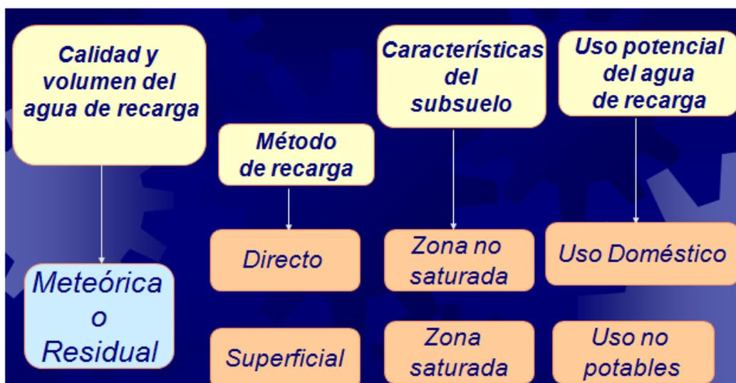
Fig. N° 07 Elementos de un proyecto de recarga artificial
