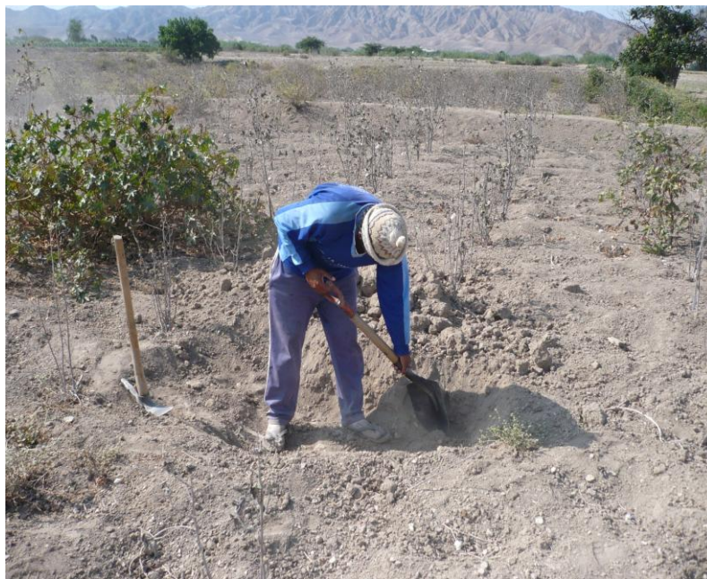
Excavación de calicata
